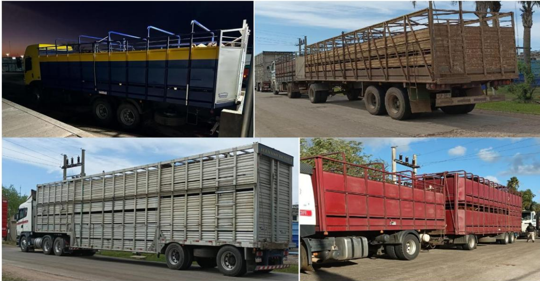
Imagen 2 Ejemplo de camiones de transporte de hacienda. Arriba izquierda: camión simple; arriba derecha: camión remolque; abajo izquierda: camión doble piso; abajo derecha: camión mixto. Extraído de Hernández y Martínez (2023).
